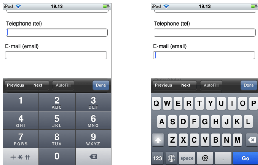
Рис. 4.8. При заполнении формы на мобильном устройстве у пользователей нет возможности работать с полной клавиатурой. В iPod их участь облегчается предоставлением клавиатуры, специализированной под конкретный тип данных. Таким образом, для ввода телефонных номеров предоставляется цифровая клавиатура в стиле номеронабирателя телефона ( слева ), а для ввода адресов электронной почты — клавиша <@> и уменьшенная клавиша пробела ( справа )
